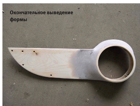
«Текстильная» часть усилена шпатлёвкой снаружи
