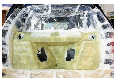
Строительство кормового сабву- ферного блока. Душераздирающее зрелище, не для слабонервных
