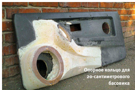
Готовая дверь с НЧ Pioneer и СЧ 25 ГДС (позже демонтированы)
