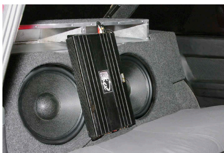
После замены усилителя с QS на КАР он перестал куда-либо помещаться и встал перед диффузорами
