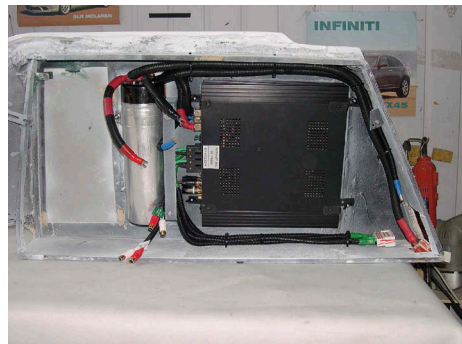
Внутри правого «стелса» — два усилителя и накопитель между ними
