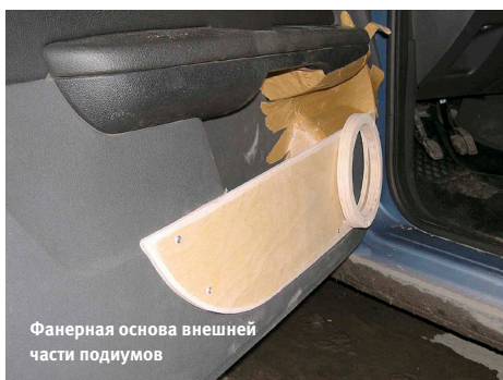
Первая версия дверных подиумов: динамик на металле двери без доворота
