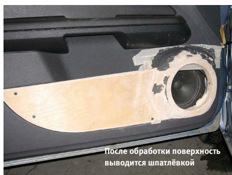
Вторая версия подиумов, с доворотом, строилась по текстильной технологии
