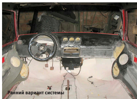
Изготовление основы нового торпеда
