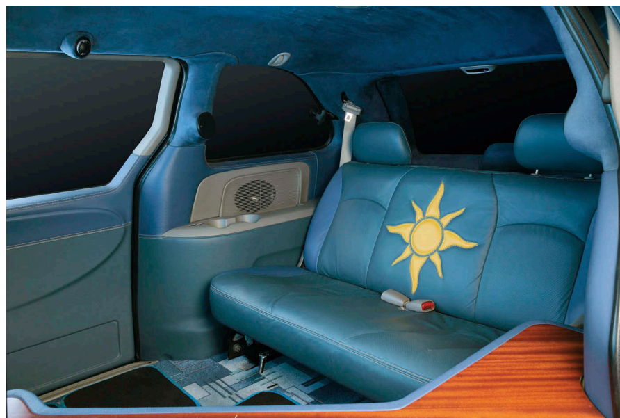
6-дюймовые басовики трёхполосной системы второй зоны встали на место штатных «лопухов»
