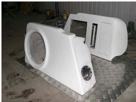
Со стороны сиденья закреплена «чашка» с терминалами
